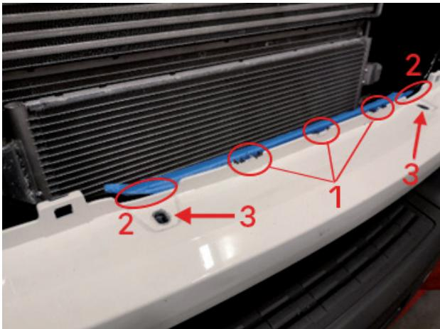
3. M6 skruven går först genom M6 karosseribrickan, genom IVECO fästplåten, genom en distanshylsa samt genom ytterligare en karosseribricka och skruvas sedan fast i befintliga mutterstycken (3) genom plaststötfångaren.
